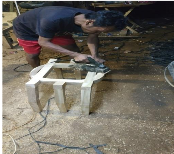
Gambar 54 Penghalusan Dengan Menggunakan Mesin Sekrap ( Sumber : M. Jauhar Ansori, 2019)
