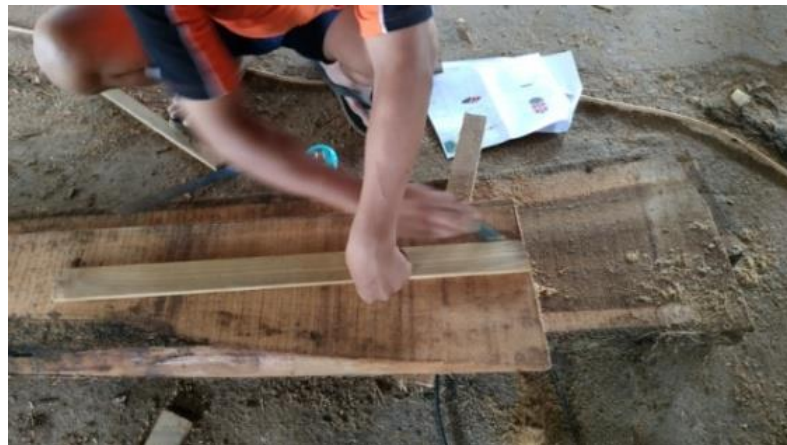
Gambar 52 Tahap Pengukuran dan Pengemalan ( Sumber: M. Jauhar Ansori, 2019)
