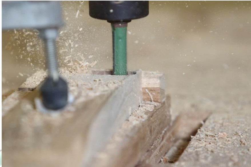
Gambar 61. Pembuatan sudut rangka kaki Sumber : Dokumentasi Penulis, 2021
