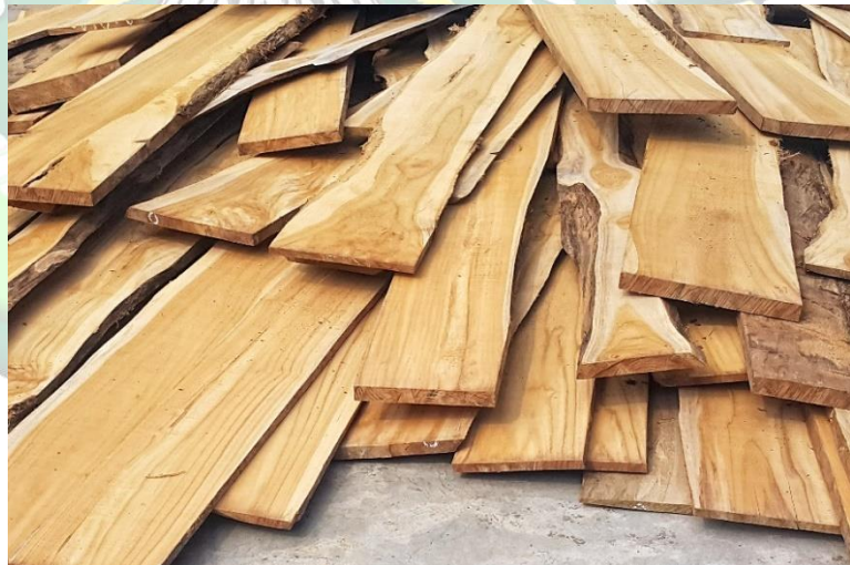
Gambar 59. Papan gergajian untuk pembahanan Sumber : Dokumentasi Penulis, 2021
