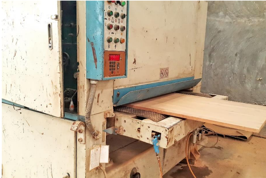
Gambar 63. Perataan permukaan kayu dengan sanding master Sumber : Dokumentasi Penulis, 2021
