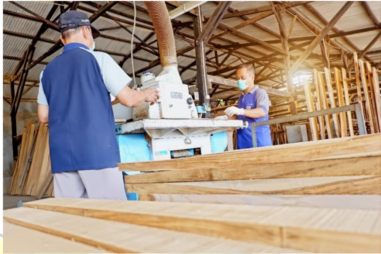
Gambar 60. Proses pembelahan papan kayu Sumber : Dokumentasi Penulis, 2021
