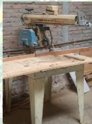
Gambar 38. Mesin Gergaji Belah ( Rip Saw ) Sumber : Dokumentasi Penulis, 2021
