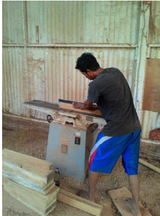
Gambar 62. Proses Perataan sisi kayu komponen menggunakan mesin jointer (Sumber: Dokumentasi Wachid, 22 Desember 2016)
