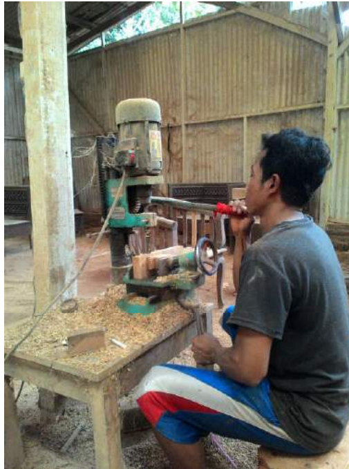
Gambar 63. Proses Pembuatan Lubang Purus (Sumber: Dokumentasi Wachid, 22 Desember 2016)
