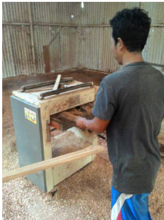
Gambar 61. Proses Perataan permukaan komponen menggunakan mesin planner (Sumber: Dokumentasi Wachid, 21 Desember 2016)
