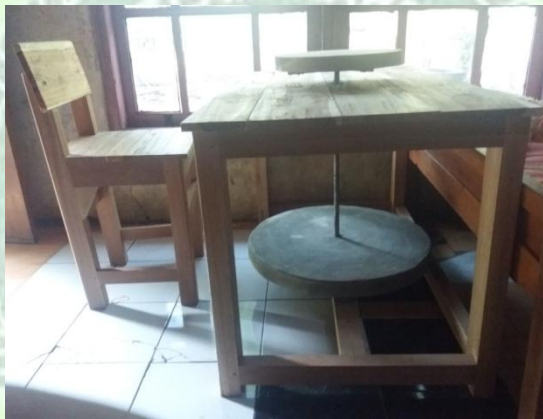
Gambar 5.1 Rancangan Alat Pembuat Keramik Sumber : Dokumentasi (2019)
