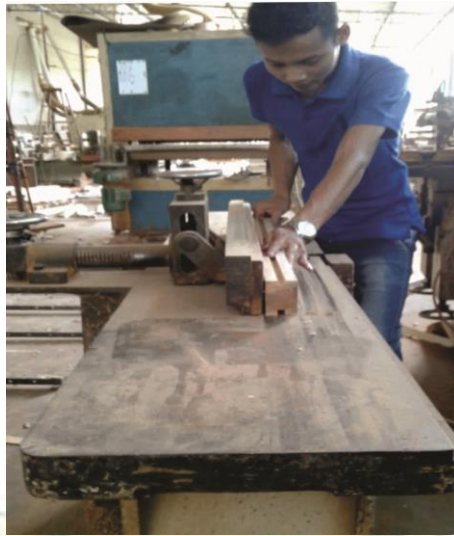
Gambar 4.11. Proses pada Mesin Jointer
