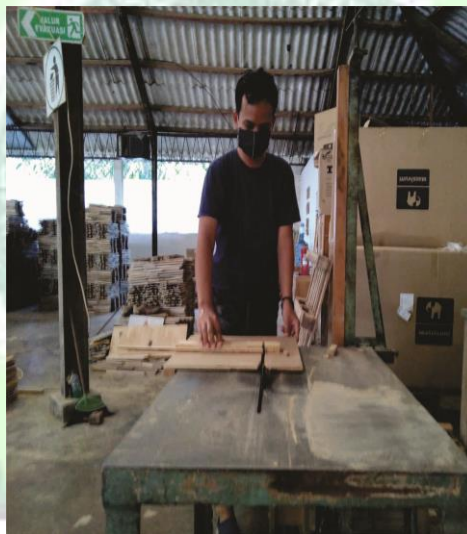
Gambar 4.12. Proses pada mesin Serkel 1
