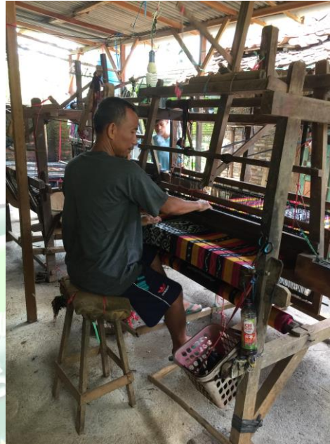
Gambar 3.3 Cara membuat kain dengan alat ATBM Tenun Ikat Aflah Jepara
