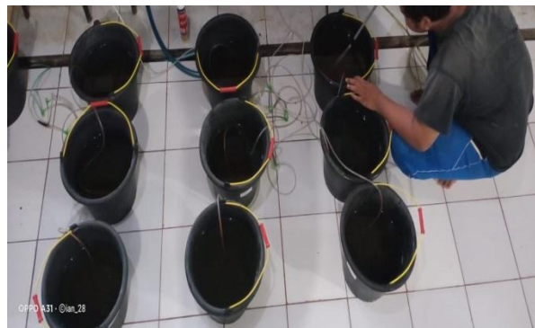
Proses Pergantian Air Dengan Cara Sipon
