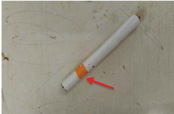
Gambar 3.4 *Ring* pada batang rokok tidak simetri
