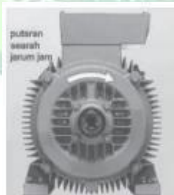
Gambar 2.6 Putaran motor dilihat dari sisi poros
