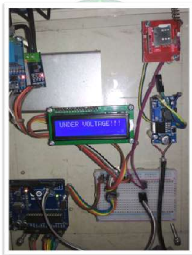
Gambar 4.4 Error Warning Saat Tegangan Trip atau dibawah 200V
