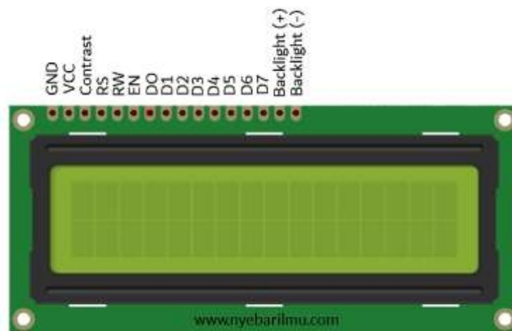
Gambar 2.24 LCD 16x2 Arduino
