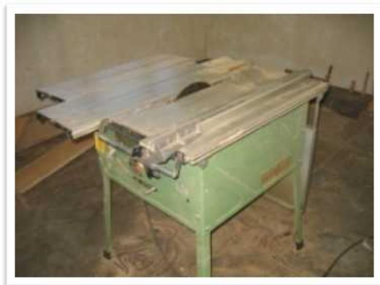
Gambar 62 : Mesin gergaji (*circle saw*)
