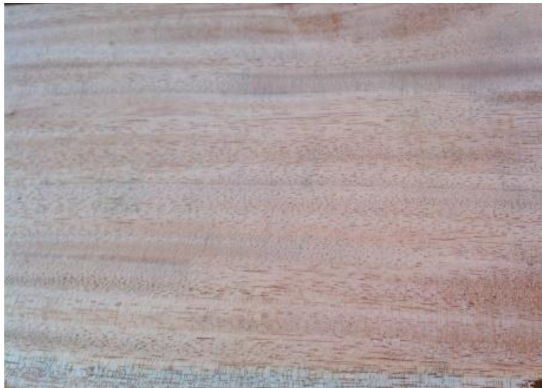
Gambar 4.6: Kayu Mahoni yang sudah dihaluskan dengan mesin Ketam
