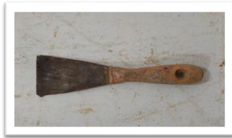
Gambar 76 Kape atau scrap (Sumber: M.Fadlun Nizar, 2019)
