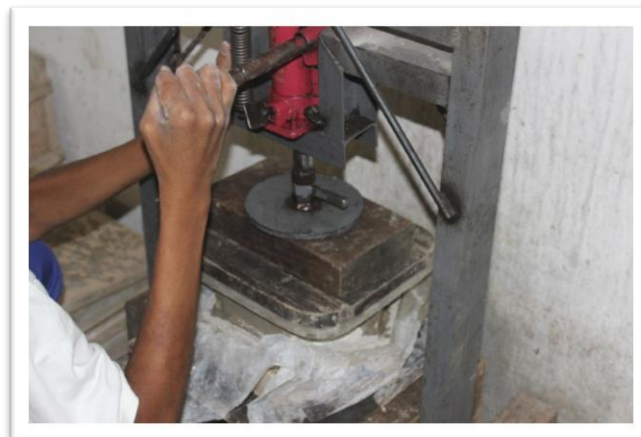
Gambar 65 Pengepresan Panel Dengan Alat Press (Sumber: M.Fadlun Nizar, 2019)
