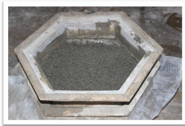
Gambar 64 Penuangan dan Perataan Bahan Kedalam Cetakan (Sumber: M.Fadlun Nizar, 2019)
