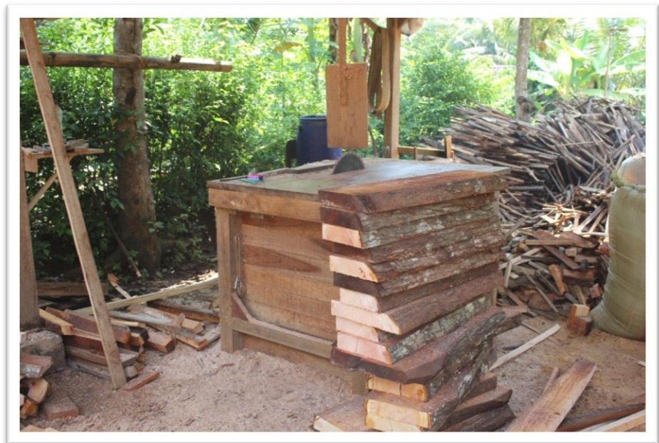
Gambar 51 Penggergajian Kayu Tahap Awal (Sumber: M.Fadlun Nizar, 2019)
