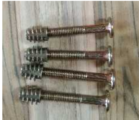
Gambar 58: Baut nanasan (Sumber: Penulis)
