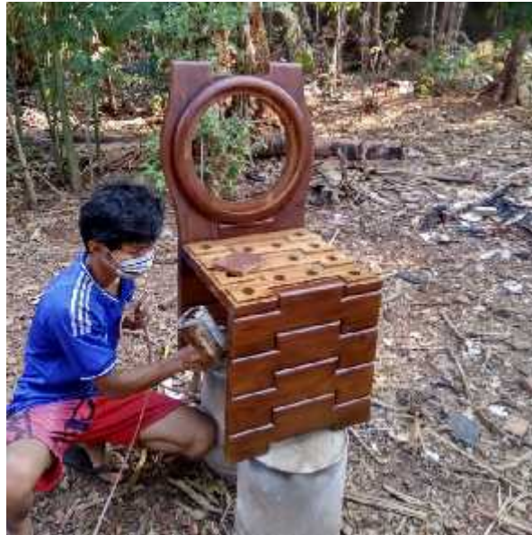
Gambar 89: Tahap top coat doff (Sumber: Penulis)
