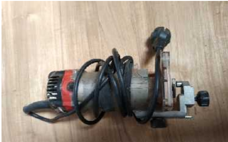
Gambar 67: Mesin Propil (Sumber: Penulis)
