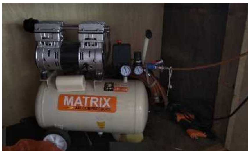
Gambar 99: kompresor dan selang (Sumber: Penulis)
