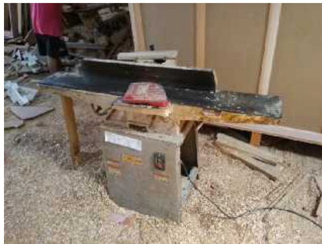
Gambar 62: Jointer (Sumber: Penulis)
