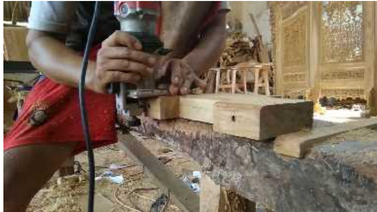
Gambar 83: Proses pembentukan pola (Sumber: Penulis)
