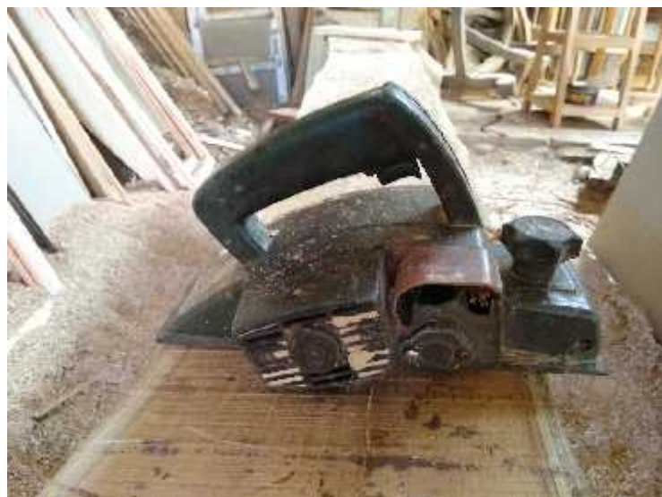
Gambar 66: Mesin Ketam (Sumber: Penulis)
