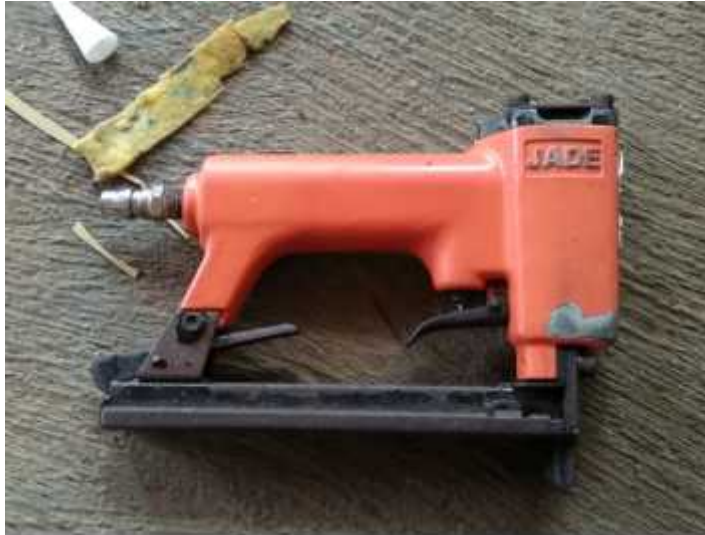
Gambar 100: Mesin staples tembak (Sumber: Penulis)
