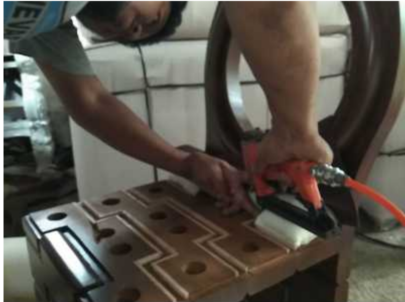
Gambar 104: Proses penembakan busa dengan mesin staples tembak (Sumber: Penulis)
