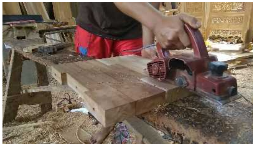
Gambar 82: Proses penghalusan komponen (Sumber: Penulis)
