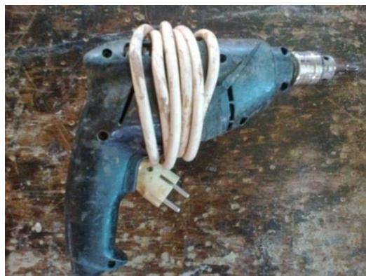
Gambar 65 : Mesin bor tangan ( *Hand Drill* )
