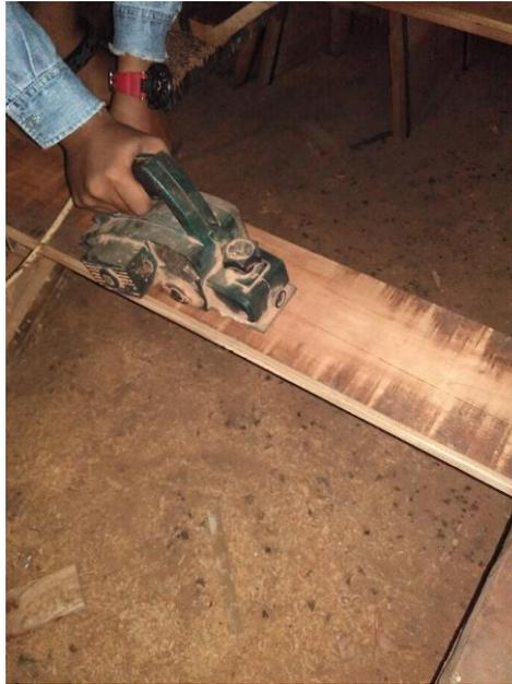
Gambar 85 : Penghalusan dengan menggunakan Mesin Ketam.
