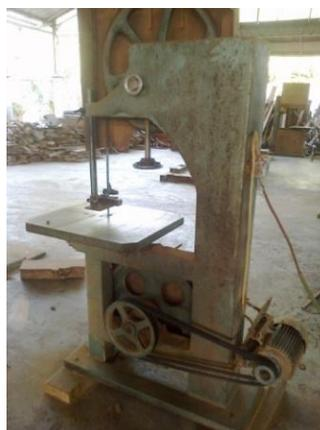
Gambar 63 : Mesin Gergaji Pita (*Band Saw* )
