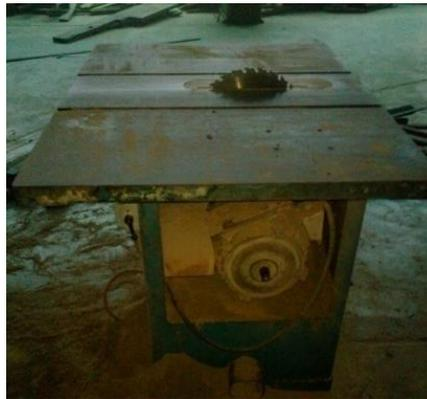
Gambar 62 : Mesin Gergaji Piringan (*Circular Saw*)
