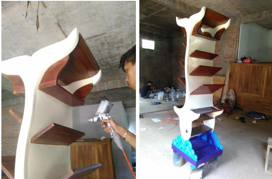
Gambar 101 : Proses tahap akhir *finishing*
