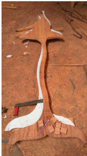
Gambar 83 : Teknik pengukuran dan pengemalan komponen.
