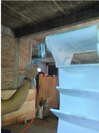
Gambar 96 : Proses cat dasar (*epoxy*)
