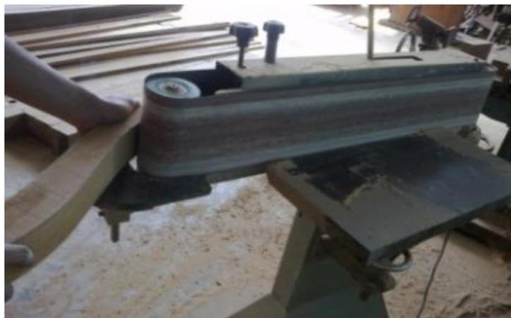
Gambar 86 : Penghalusan dengan menggunakan mesin amplas selendang
