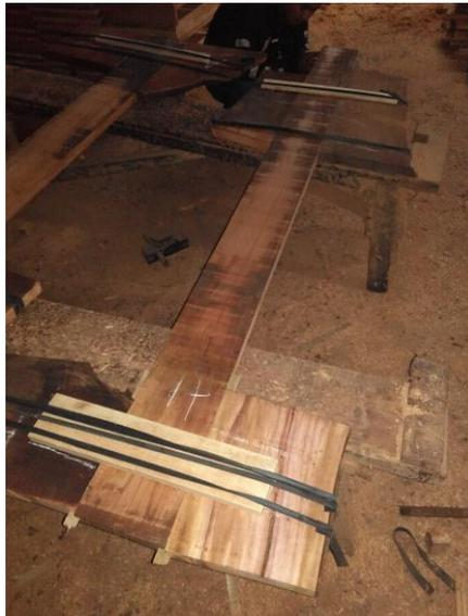
Gambar 84 : Teknik Penyambungan Papan
