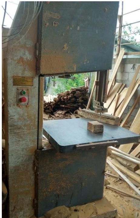
Gambar 67: Mesin Gergaji Pita( *Band Saw* )
