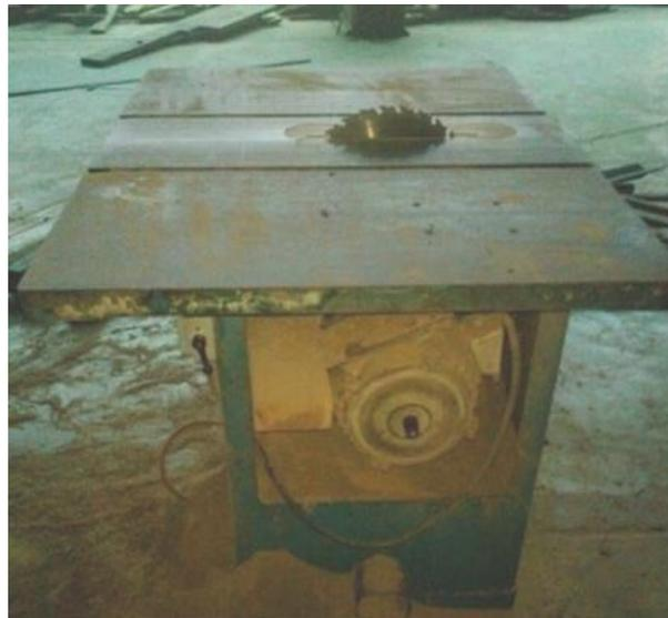
Gambar 66: Mesin Gergaji Piringan (*Circular Saw*)
